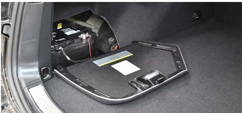
Ubicación de la instalación en el maletero (por ejemplo, Superb)
