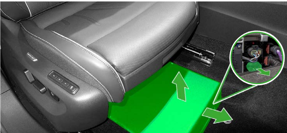
Desconexión del sistema de 48 V del modelo Superb a partir del año 2023
