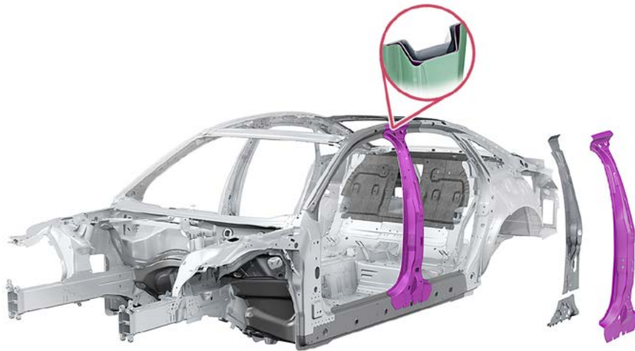
Pilar B con estructura multicapa
