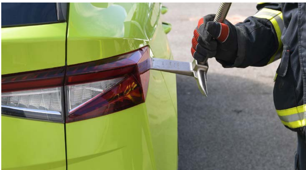
En los vehículos fabricados a partir de 2023, el punto de corte del alto voltaje también se encuentra detrás de la luz trasera derecha
