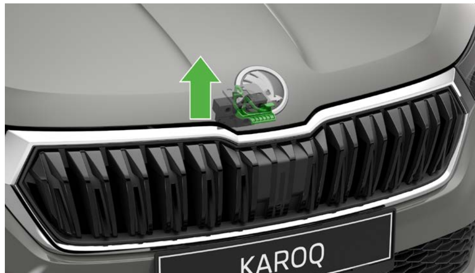
En el capó: desbloqueo de la cerradura (por ejemplo, en Karoq)
