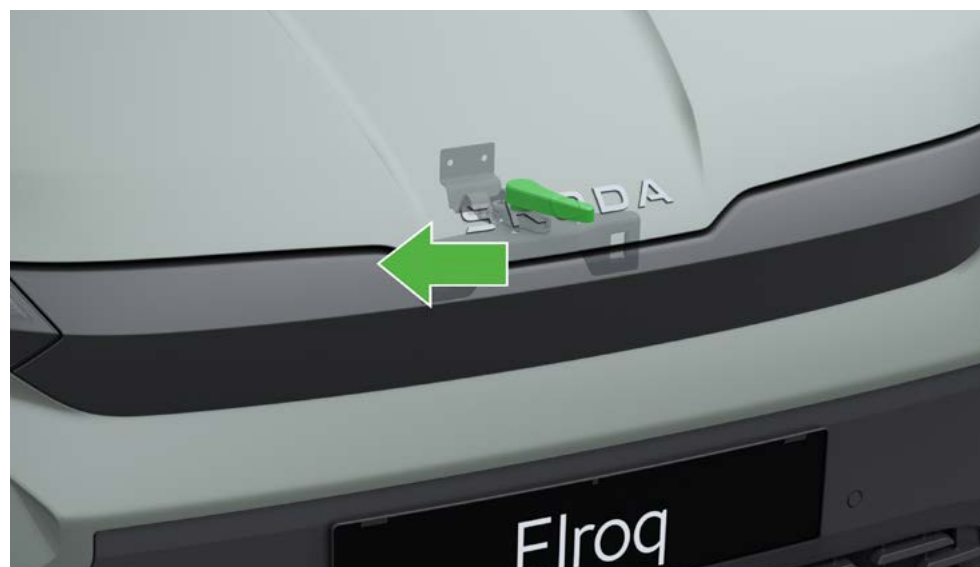
En el capó: desbloqueo de la cerradura (por ejemplo, en Enyaq)
