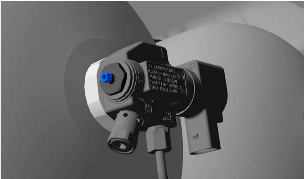
Girar la válvula de cierre hasta el tope en el sentido de las agujas del reloj con una llave de boca de 5 mm, unos alicates o una herramienta especial
