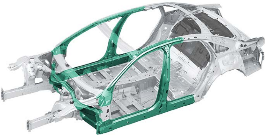
Carrocería con el compartimento de pasajeros reforzado
